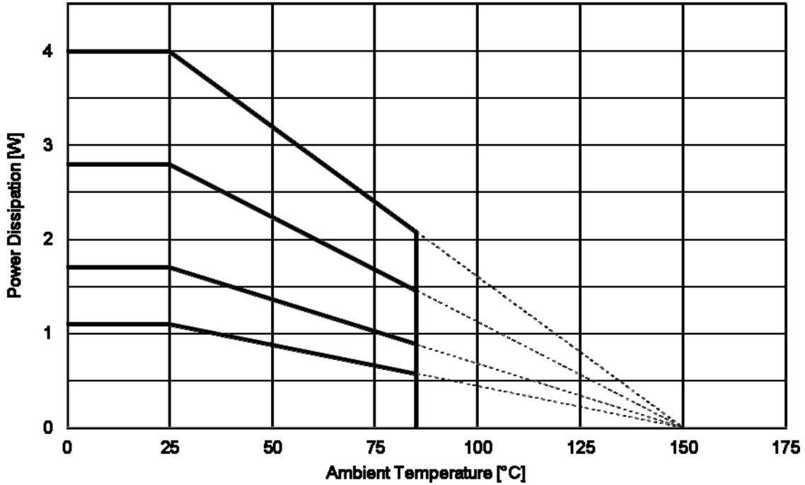
Figure 23. Power Dissipation
