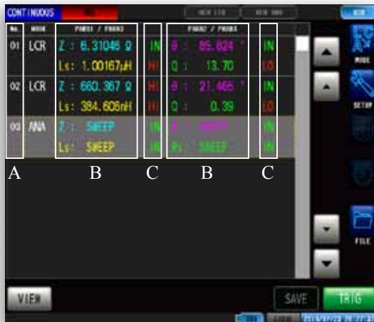
A: Nummer des Einstellsatzes für die kontinuierliche Messung; B: gemessene Werte; C: Ergebnisse der Parameter-Auswertung
