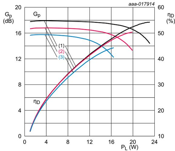
$V_{DS} = 28\text{ V}$ ;  $I_{Dq} = 110\text{ mA}$ ;  $f = 2600\text{ MHz}$ ;  $\delta = 10\%$ ;  $t_p = 100\text{ }\mu\text{s}$ .
