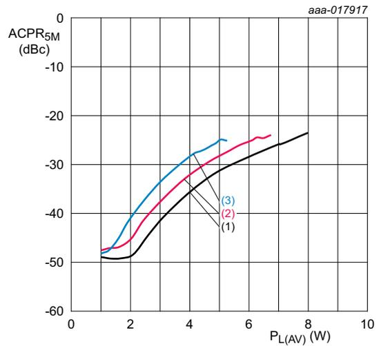
$V_{DS} = 28\text{ V}$ ;  $I_{Dq} = 110\text{ mA}$ ;  $f = 2600\text{ MHz}$ ;
