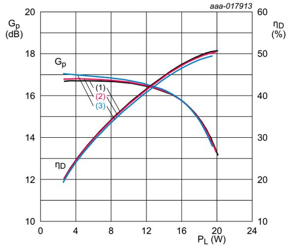
$V_{DS} = 28\text{ V}$ ;  $T_{case} = 25\text{ °C}$ ;  $f = 2600\text{ MHz}$ ;  $\delta = 10\%$ ;  $t_p = 100\text{ }\mu\text{s}$ .
