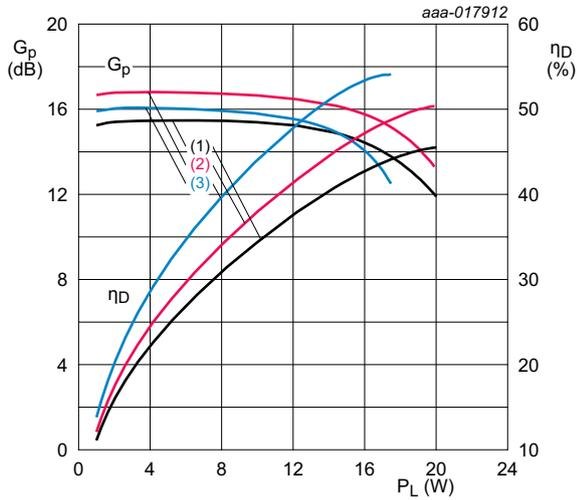
$V_{DS} = 28\text{ V}$ ;  $I_{Dq} = 110\text{ mA}$ ;  $T_{case} = 25\text{ °C}$ ;  $\delta = 10\%$ ;  $t_p = 100\text{ }\mu\text{s}$ .
