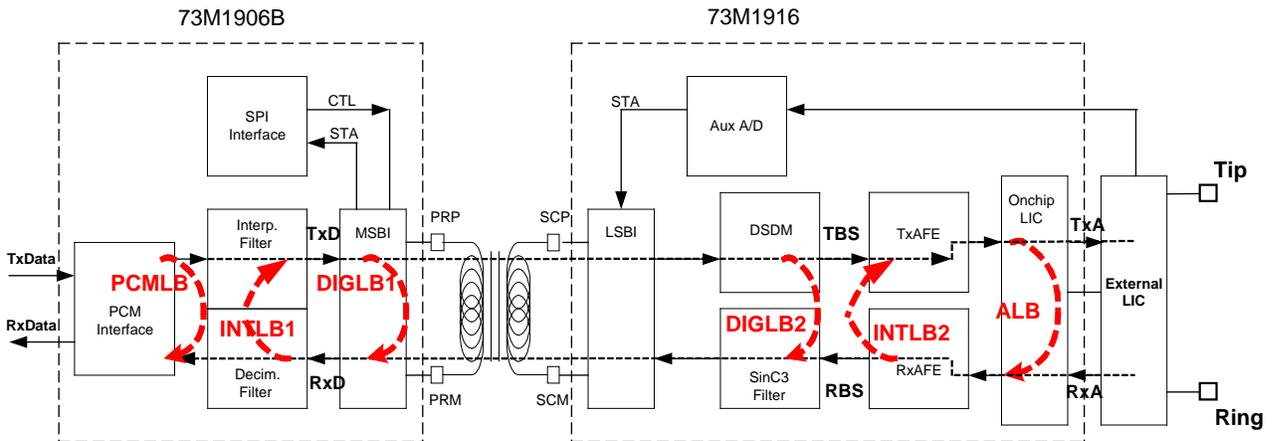
**Figure 39: Loopback Modes Highlighted**
