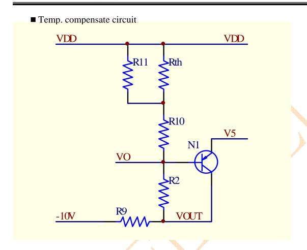
Rth 为温度补偿电阻 VDD 与 V5 之间接 LCD 驱动电路(BIAS 电路) -10V 为负压 IC 输出的电压 VO 与 VOUT 为 LCM 接口定义脚 电阻标识与 PCB 板上标识一致
