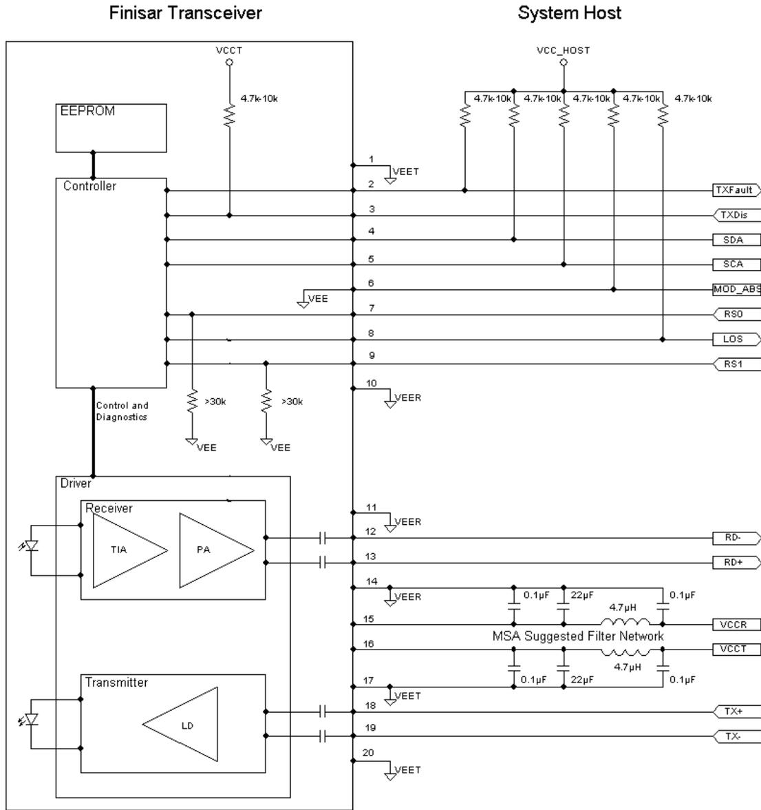
**Figure 5. Host-Module Interface**
