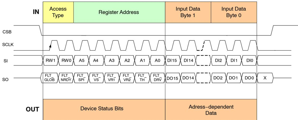
Figure 18. SPI Frame
