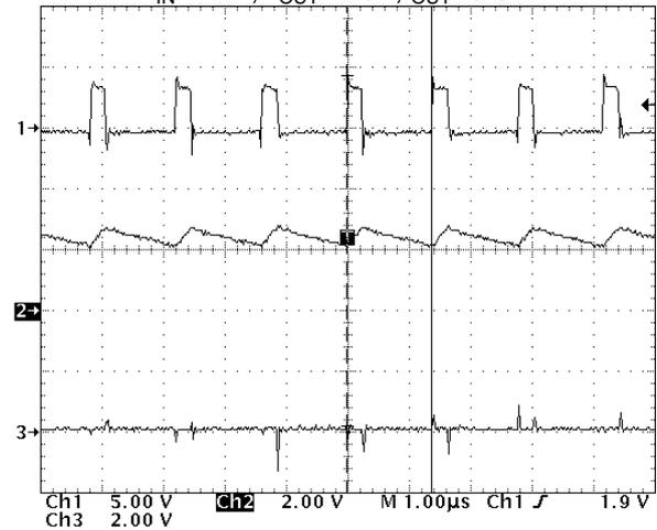
CH1 :  $V_{sw}$  , CH2 :  $I_L$  , CH3 :  $V_{out}$
