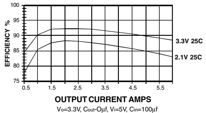
$V_o=3.3V$ ,  $C_{out}=0\mu f$ ,  $V_i=5V$ ,  $C_{in}=100\mu f$
