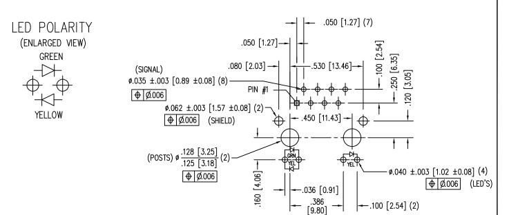
P.C.B. RECOMMENDED HOLE LAYOUT SEEN FROM COMPONENT SIDE
