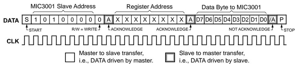
**Figure 22. Write Byte Protocol**
