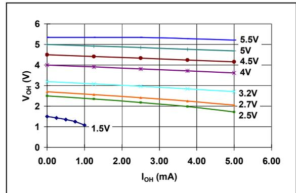
**FIGURE 2-26:**  $V_{OH}$  vs.  $I_{OH}$  (MCP1319-2.9 @  $25^\circ\text{C}$ ).
