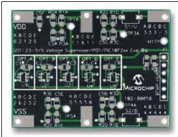
**FIGURE 1:** SOT-23-5/6 Voltage Supervisor Evaluation Board (VSUPEV2).
