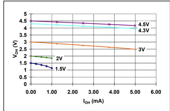
**FIGURE 2-25:**  $V_{OH}$  vs.  $I_{OH}$  (MCP1318M-4.6 @  $25^\circ\text{C}$ ).
