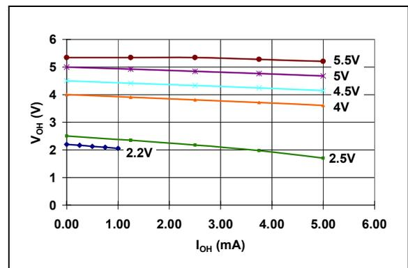
**FIGURE 2-27:**  $V_{OH}$  vs.  $I_{OH}$  (MCP1316-2.0 @  $25^\circ\text{C}$ ).
