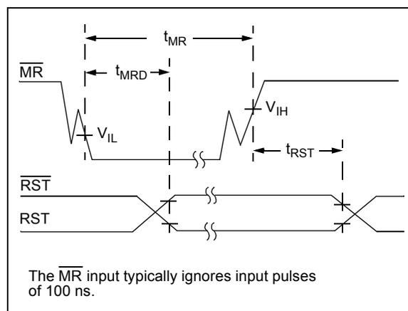
**FIGURE 4-18:**  $\overline{\text{MR}}$  Input – Push Button.
