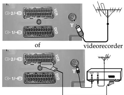
De aansluiting via de Euroconnector (scart kabel) is optioneel.
