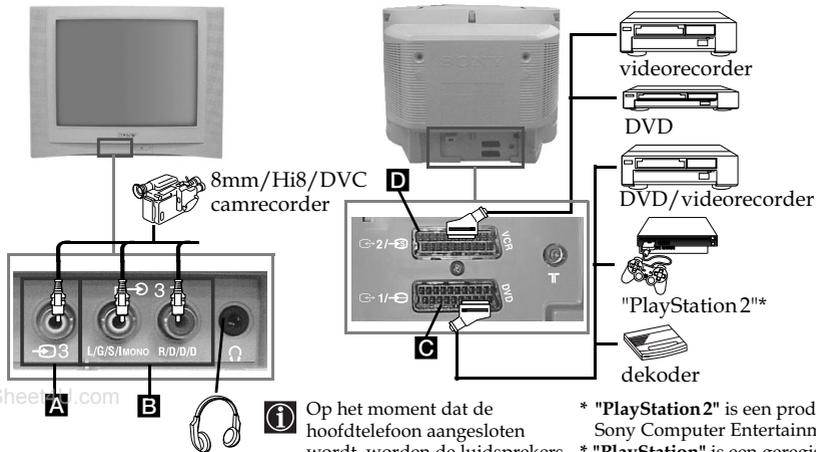
**i** Op het moment dat de hoofdtelefoon aangesloten wordt, worden de luidsprekers van het TV-toestel automatisch uitgeschakeld.
