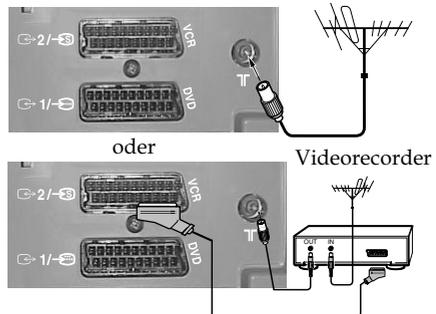
Der Anschluss über ein Scart-Kabel ist optional.
