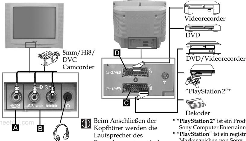
**i** Beim Anschließen der Kopfhörer werden die Lautsprecher des Fernsehers automatisch ausgeschaltet.
