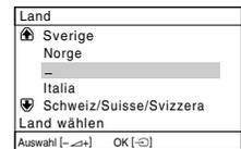
**4** Vergewissern Sie sich, dass das Fernsehgerät korrekt an die Antenne angeschlossen ist und bestätigen Sie dann mit
