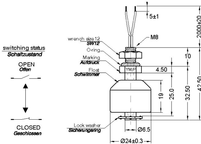
Abmessungen / dimensions (mm)
