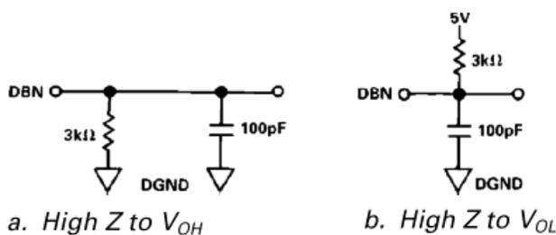
FIGURE 2. LOAD CIRCUITS FOR BUS RELINQUISH TIME ( $t_7$ )
