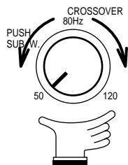
Wählen Sie eine Übergangsfrequenz zwischen 50 und 120 Hz mit dem CROSSOVER FREQUENCY Regler (Übergangsfrequenz).
