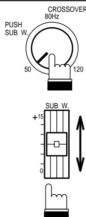
Die LED am SUBWOOFER LEVEL (Tieftöner-stufen-) Regler leuchtet nicht, wenn der SUBWOOFER ON/OFF Schalter (Tieftöner ein/aus) AUSgeschaltet ist. In diesem Modus sind die FRONT und HECK-Ausgänge Vollbereichs-Signale, ohne Signal an den SUBWOOFER (Tieftöner-) Ausgang.
