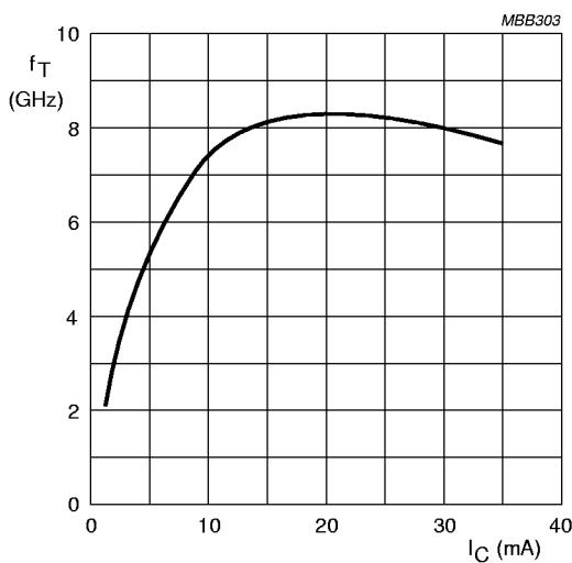
$V_{CE} = 8$  V;  $T_{amb} = 25$  °C;  $f = 2$  GHz.
