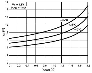
FIGURE 10. ON-RESISTANCE vs SWITCH VOLTAGE
