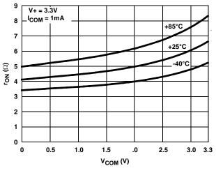
FIGURE 12. ON-RESISTANCE vs SWITCH VOLTAGE
