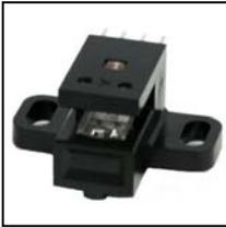
KE-2H18シリーズは、発光素子に赤外LEDを使用した薄型且つギャップ2mmの「光学式エンコーダ」です。発光素子および受光フォトICに自社製品を採用しており、高品質、経済性を両立させています。分解能は150、180LPIを取り揃えており、デジタル出力で幅広い用途にご使用いただけます。
