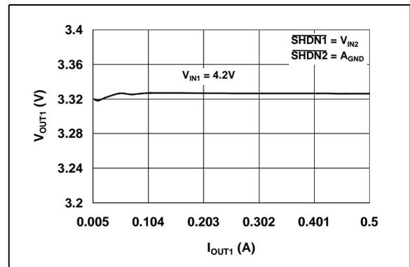
**FIGURE 2-12:**  $V_{OUT1}$  vs.  $I_{OUT1}$  ( $V_{OUT1} = 3.3V$ ).
