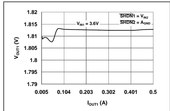
**FIGURE 2-11:**  $V_{OUT1}$  vs.  $I_{OUT1}$  ( $V_{OUT1} = 1.8V$ ).
