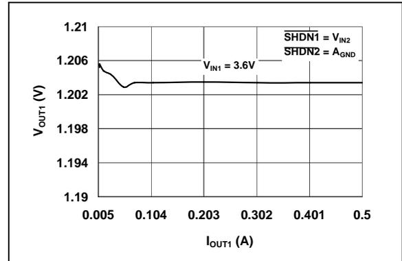
**FIGURE 2-10:**  $V_{OUT1}$  vs.  $I_{OUT1}$  ( $V_{OUT1} = 1.2V$ ).
