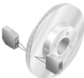
Misurazione dello spessore dei dischi di freni
