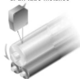
Misurazione dello spazio fra gli elementi di una cinghia in gomma
