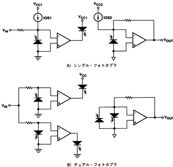
図14 . バイポーラ動作回路
