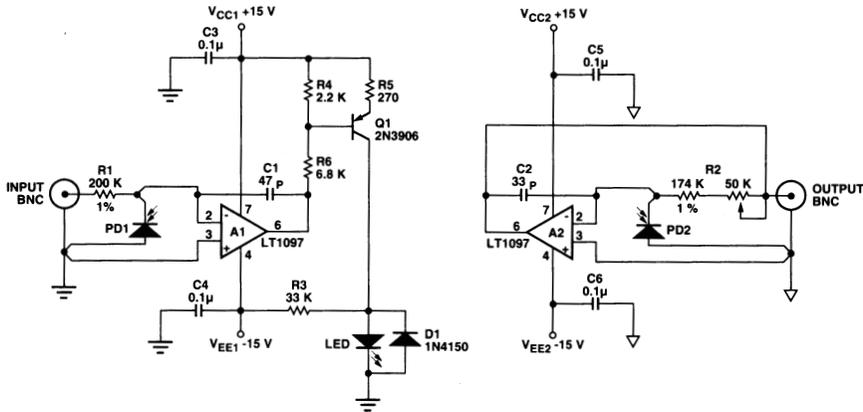
図17. 高精度アナログ絶縁アンプ
