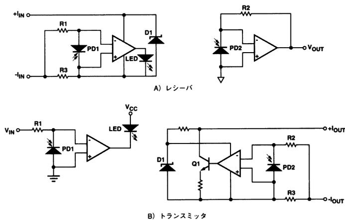
図15 . 4 ~ 20mA電流ループ回路
