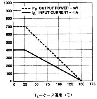
図11. VDE0884における温度ディレーティングカーブ (故障時の安全限界)
