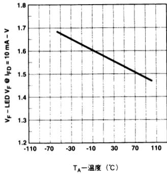
図10. LED順方向電圧対温度
