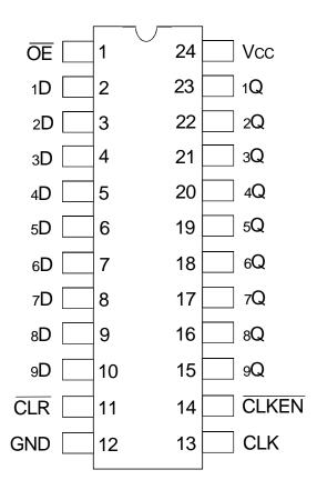
SOIC/ SSOP/ QSOP/ TSSOP TOP VIEW
