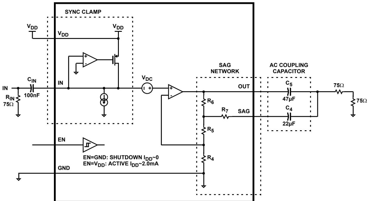
FIGURE 3. BLOCK DIAGRAM
