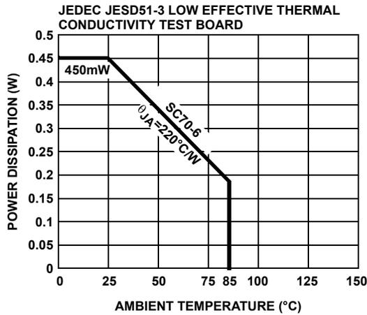
FIGURE 1. PACKAGE POWER DISSIPATION vs AMBIENT TEMPERATURE
