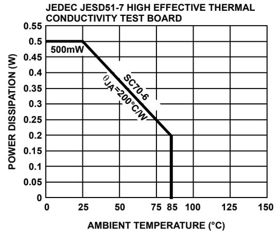
FIGURE 2. PACKAGE POWER DISSIPATION vs AMBIENT TEMPERATURE
