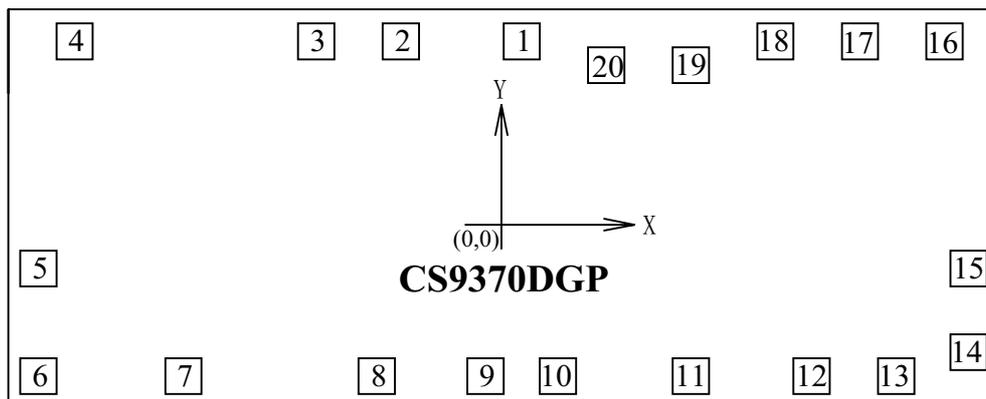
建议：芯片衬底接  $V_{SS}$ ，载片岛面积为  $4.230\text{mm} \times 3.015\text{mm}$
