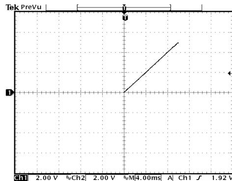
**$V_+ = 3\text{V}$ ,  $V_- = 0\text{V}$ ,  $R_L = 2\text{K}\Omega$**
