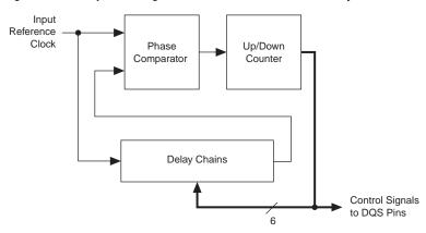
Figure 2-68. Simplified Diagram of the DQS Phase Shift Circuitry
