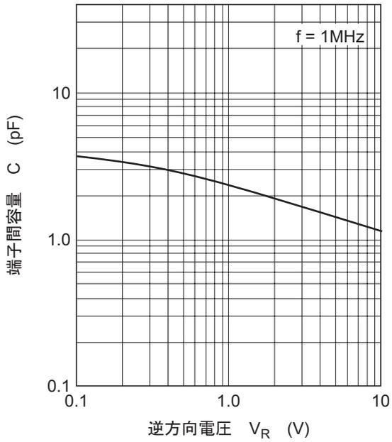
图3. 端子間容量 对 逆电压特性
