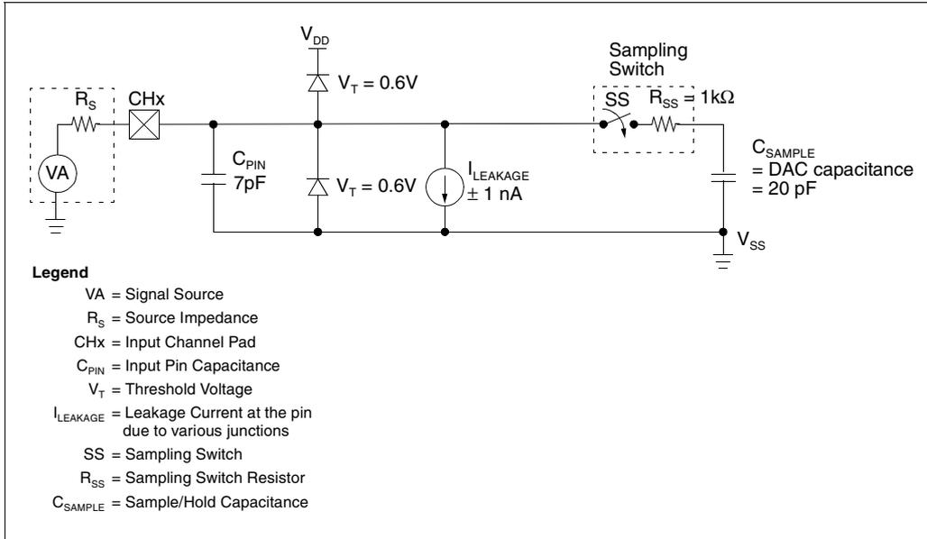
FIGURE 4-1: Analog Input Model
