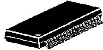
Outline 42P2R-A 0.8mm pitch 450mil ssop (8.4mm×17.5mm×2.0mm)
