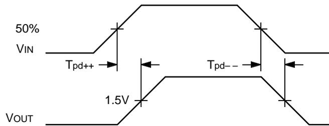
**ECL/TTL WAVEFORMS: RISE AND FALL TIMES**
